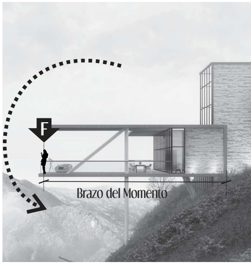
Ejemplo del momento que debe soportar la estructura de un voladizo para estar en equilibrio
